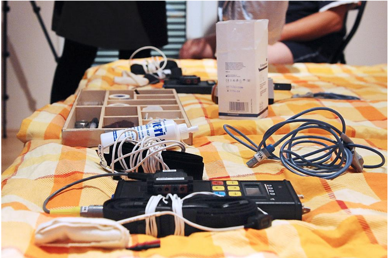
Ein Teil des wissenschaftlichen Equipments zur Schlafaufzeichnung: Elektroden, Fingerpulssensoren, Material zur Hautreinigung usw.
